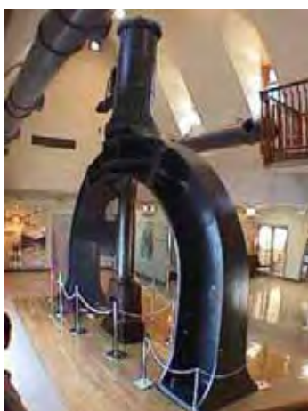
【スチームハンマー（旧横須賀製鉄所設置、1865年 オランダ製、3トン門形）ヴェルニー記念館所蔵】 （神奈川県横須賀市）
