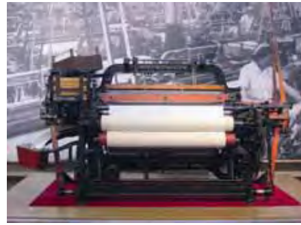
【無停止杼換式豊田自動織機（G型）】 （産業技術記念館所蔵） （愛知県名古屋市西区）
