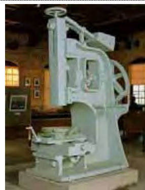
【NSBM社製の豎削盤（三菱重工業㈱長崎造船所史料館所蔵）】 （長崎県長崎市）
